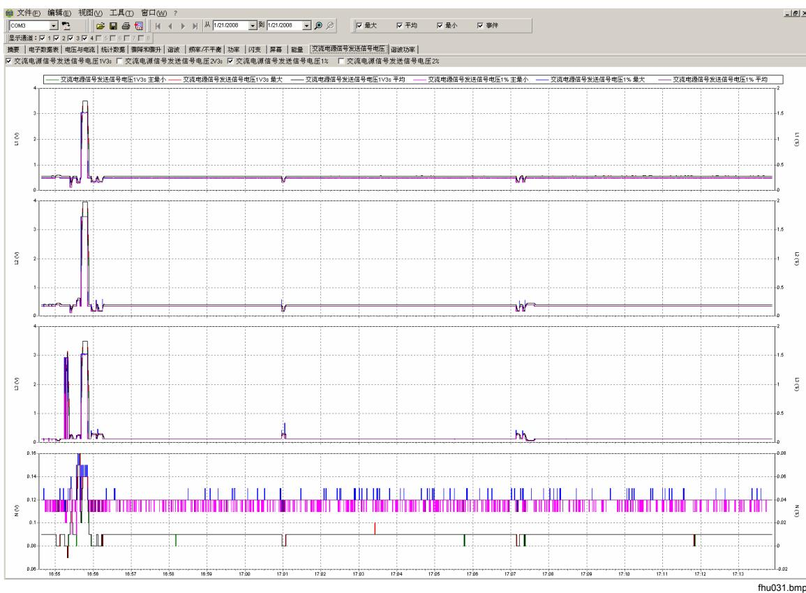
图 18. 交流电源信号发送信号电压波形
