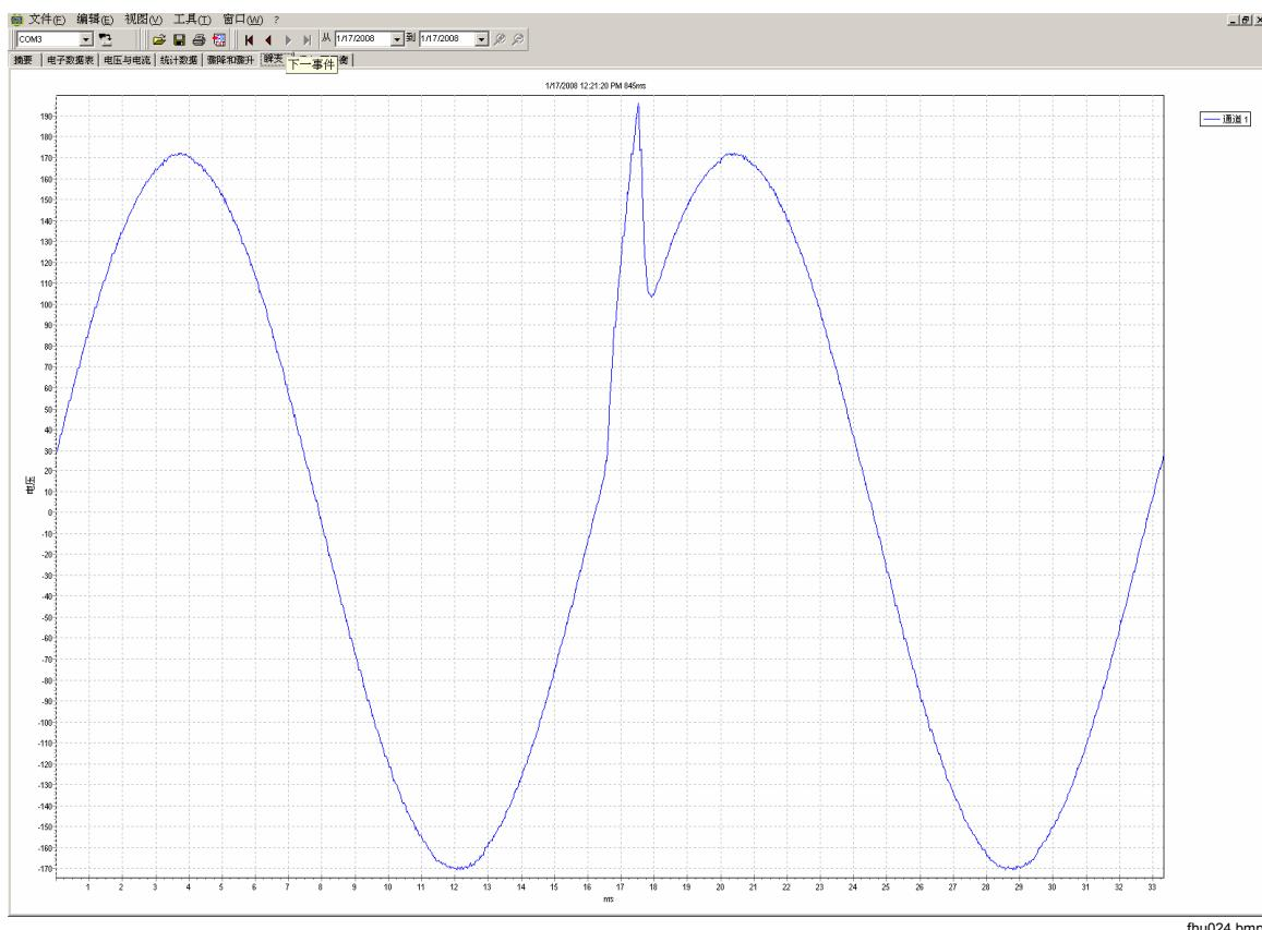
图 12. 瞬变波形
